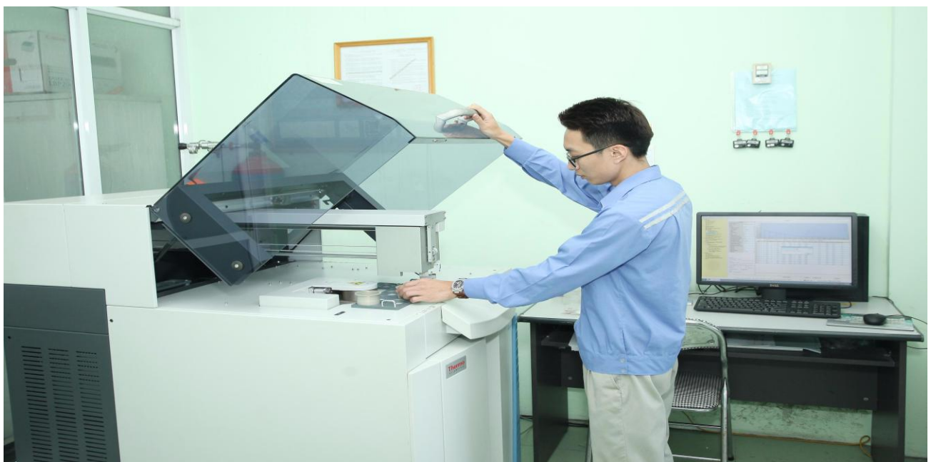
Phân tích Các thành phần oxit trên máy Quang phổ Huỳnh Quang tia X (XRF)
